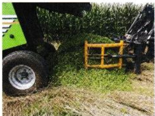
写真6-2. 梱包圧最大設定、ネット張力2.4倍に設定し、ネットの巻き数は通常とした場合の梱包・排出状況 排出段階で荷崩れを起こし、ラップ不可能でした。
