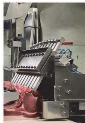
筋入れ作業、骨引き作業の際に肉が動かないように固定する
