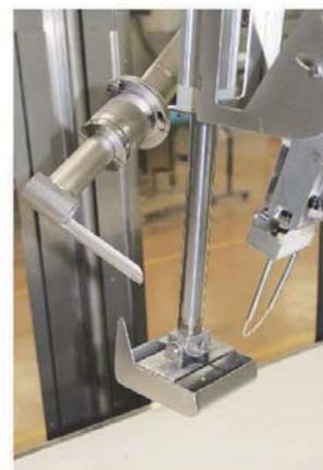
ガイドに沿ってワイヤを肋骨先端に引っ掛け、ワイヤの巻取りによって骨を剥離する。(ハンドの押さえ機構がサポート)
