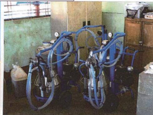
写真8 イタリア製の移動式搾乳機
