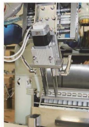
肋骨先端部から背骨関節に向かい、湾曲した肋骨の位置情報に基づき移動しながら肋骨の両脇をカットする
